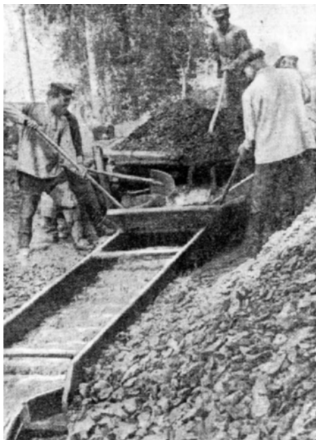
Фото 1. Промывка песков с помощью простейших приборов. (Приводится по: Ванеев Н.И. Золото. М., 1941. С. 88.).
