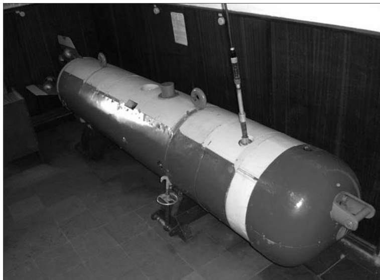
Рис. 1. Автономный необитаемый подводный аппарат «Л-1», переданный в Тихоокеанский военно-морской институт им. С.О. Макарова в рамках научно-технического сотрудничества.
