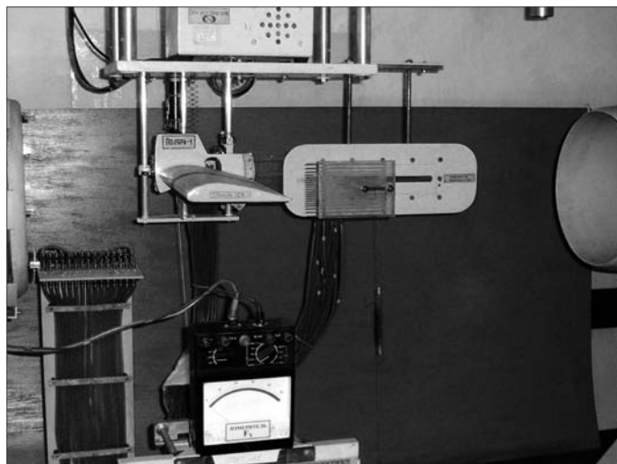
Рис. 7. Установка для исследования подъемной силы крыла в потоке воздуха дозвуковой скорости.
