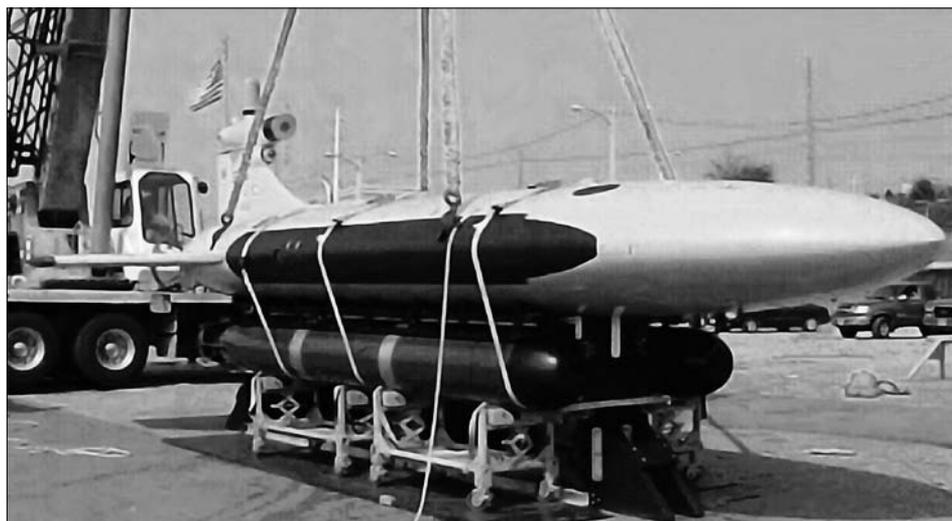
Рис. 5. Автономный НПА STDV с торпедами калибра 533 мм на внешней подвеске (вместо торпед могут подвешиваться самотранспортирующиеся или донные мины).
